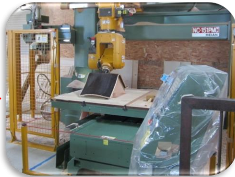
3DのNCで外周加工する事により、さまざまな形状に加工出来ます。
